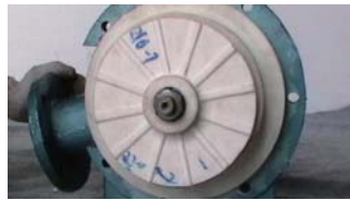
26. 逆时针方向旋上防转螺母
