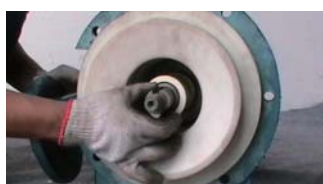
21. 套入叶轮顶圈
