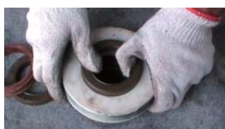
5. 装入第二只K形密封圈（唇口向下）
