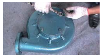
36. 用螺栓与泵壳连接，并对角均匀拧紧
