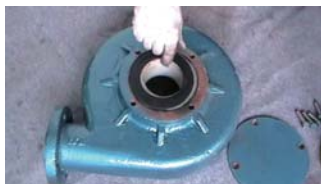
33. 在泵壳一端放上闷盖垫
