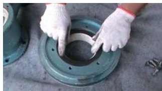
1. 在后泵盖上放置吸入口三通垫床
