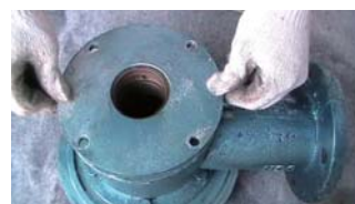
12. 安装密封盒压盖（内侧有台阶端朝下）
