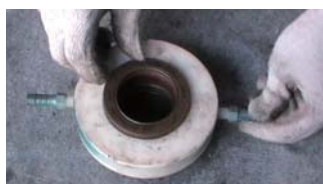
9. 在密封盒侧面拧上两只冷却水嘴 ※注①
