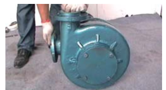
40. 将吸入口三通接管调节至水平位置
