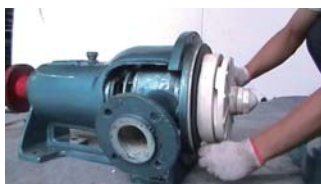
37. 在后泵盖上套入后泵盖垫
