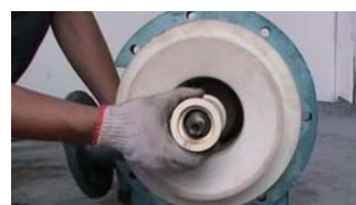
20. 套入前轴套（台阶深的一端朝外）
