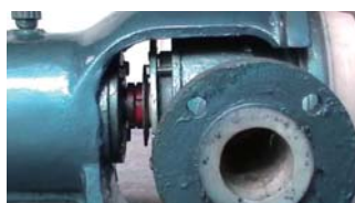
18. 装上装配好的吸入口三通接管组件
