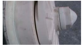
32. 检查叶轮与后泵盖之间的间隙 ※注②
