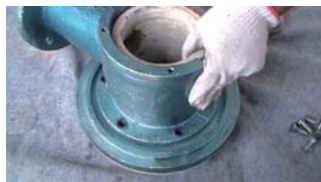
2. 在后泵盖上安装吸入口三通接管
