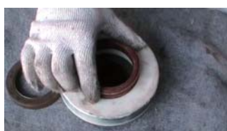
6. 装入水封环（外侧有台阶端朝上）
