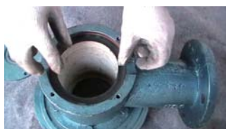
10. 在吸入口三通接管上放置密封盒垫
