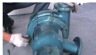
39. 用螺栓连接，注意：此时无需将螺栓拧紧！
