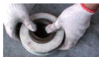
8. 装入第三只K形密封圈（唇口向下）
