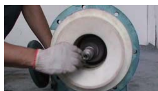
19. 在主轴前端套入前轴套垫
