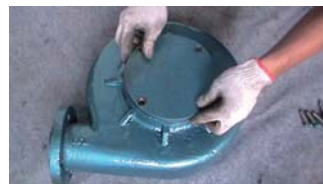
35. 装上闷盖压板
