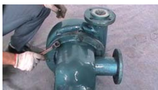
41. 对角均匀拧紧泵壳与轴承座的连接螺栓 ※注③
