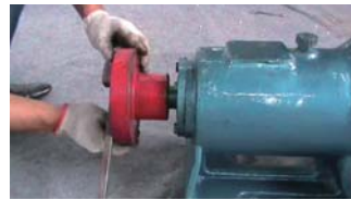
27. 固定联轴器，防止主轴转动
